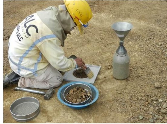
Puente vehicular río Lili. Ensayo in situ de compactación del relleno, mediante el cono y la arena.
